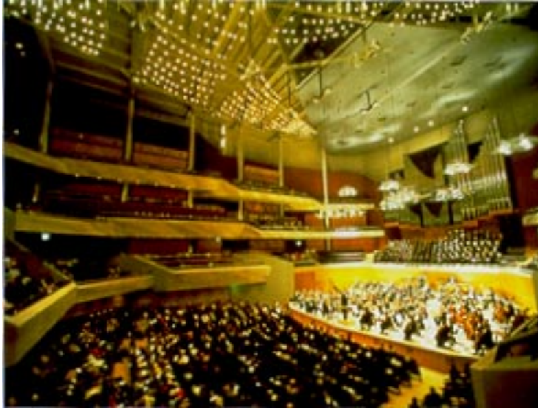
Figure 8 Bridgewater Hall, Manchester (inauguré en 1996, 2400 places). Une conception hybride avec des balcons latéraux occupés par un public clairsemé dont les structures assurent avec les murs latéraux les réflexions latérales de 2 e ordre.
