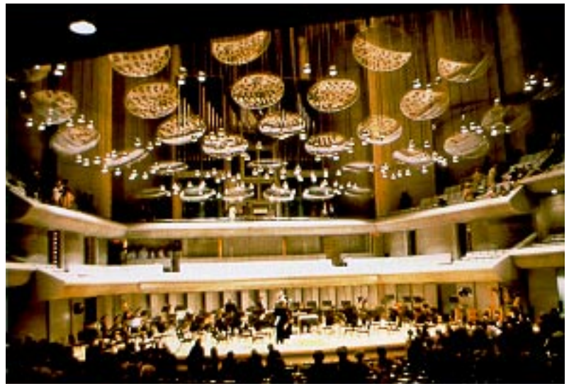
Figure 6 Roy Thomson Hall, Toronto (inauguré en 1982, 2812 places). Des réflecteurs en plastique au-dessus de la scène assurent des réflexions précoces de nature à compenser la distance importante entre la plupart des spectateurs et les murs de côté. Le son est d'une grande clarté (pour certain, trop) mais manque de présence, de force et d'éclat.
