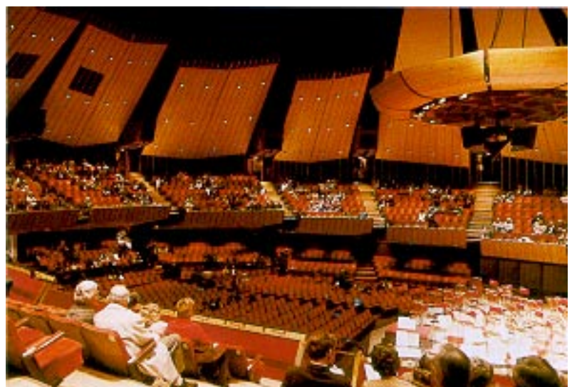
Figure 7 Christchurch Town Hall, Nouvelle-Zélande (inauguré en 1972, 2662 places). Des surfaces réfléchissantes sont suspendues sur les côtés pour générer des réflexions latérales vers de nombreux spectateurs. Avec ses nombreux sons dirigés d'abord directement vers le public, cette salle ne sonne pas avec la même vigueur qu'une salle avec des murs verticaux parallèles.
